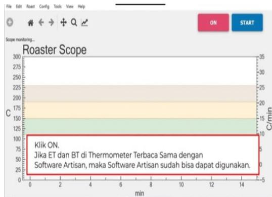
**Gambar 14 :** Klik on yang ada di pojok kanan atas lalu ET dan BT akan terbaca oleh software jika sudah terbaca maka Software Artisan Sudah dapat digunakan.
